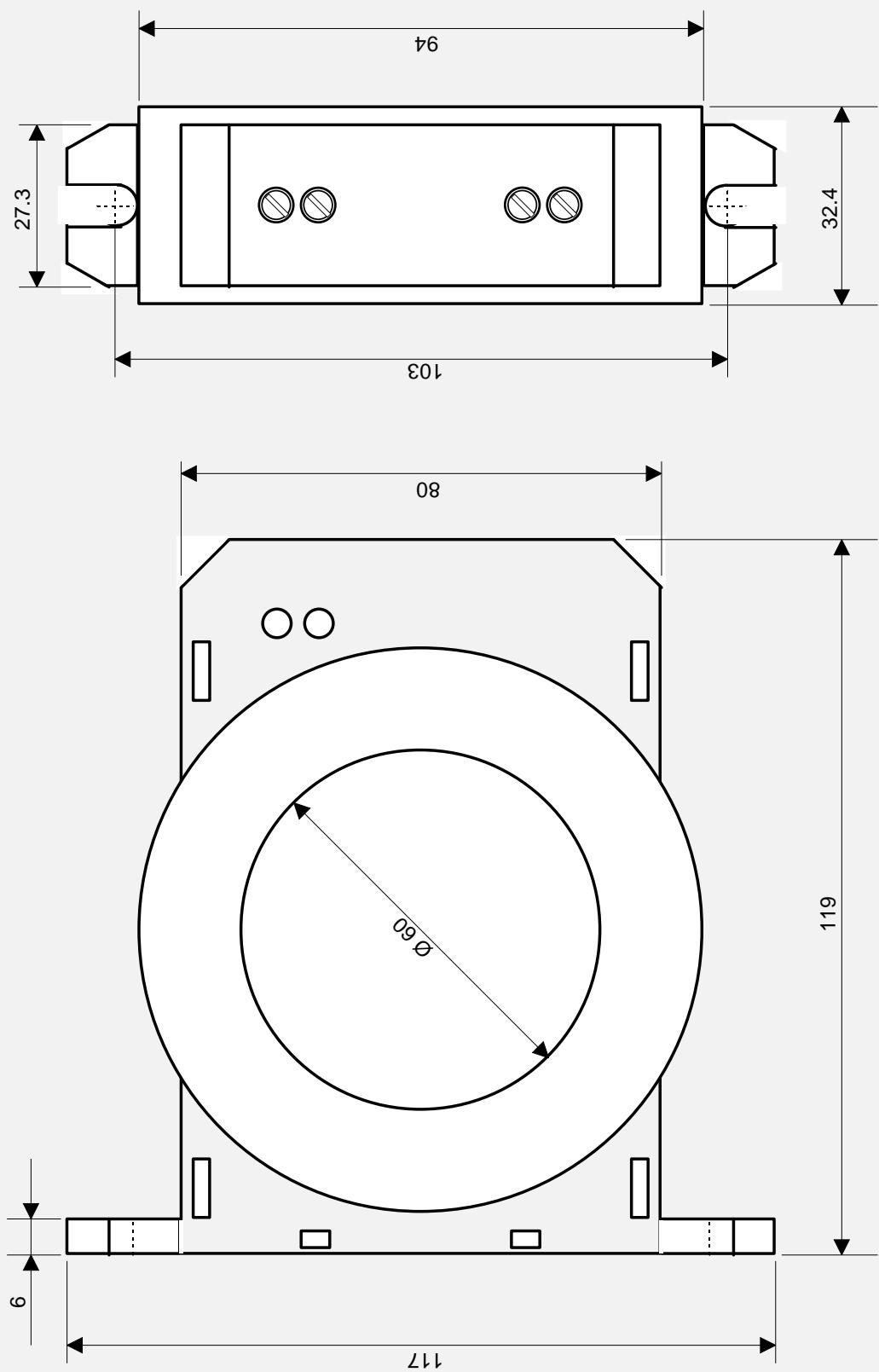
DIMENSIONES TRANSFORMADOR TOROIDAL: TRDF60
